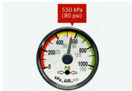
FIGURE 70 | Manomètre indiquant une pression de 550 kPa (80 lb/po 2 )
